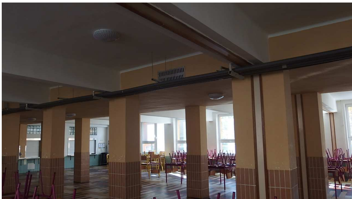
Foto č.5 – pohled na sloupky ve středu dispozice, na nejbližším sloupu stěnová dilatace a navazující stropní dilatace
