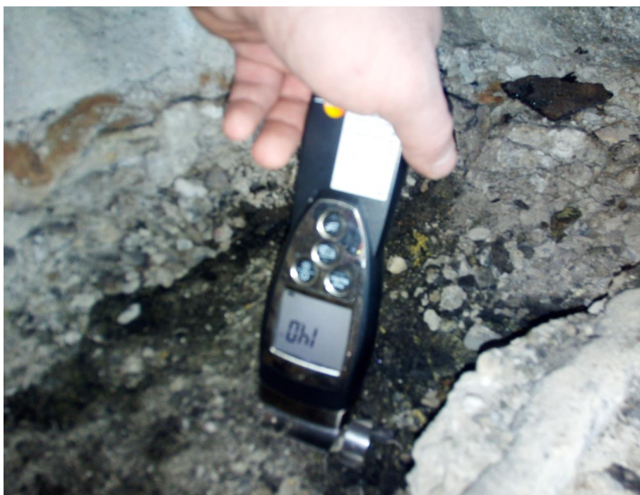
Obr. 7 Podloží podlahy na terénu – měření vlhkosti
