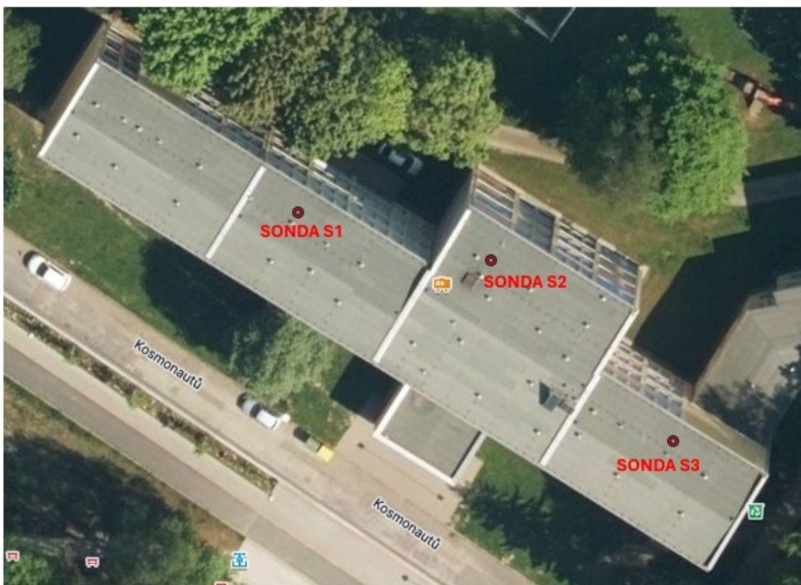
Obr.1 Schéma umístění sond do střešního pláště ZŠ a MŠ Kosmonautů 2218/13
